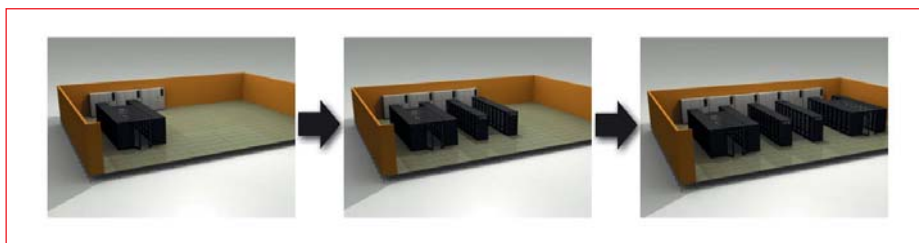
Při rozšiřování datacentra lze flexibilně zvětšovat a přeskupovat oblasti s běžným chlazením (do 5 kW/rack), řízeným tokem vzduchu (do 15 kW/rack) a aktivním systémem chlazení (do 30 kW/rack)
